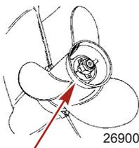
4. Поместите между коробкой передач и гребным винтом деревянный брусок для удержания гребного винта и снимите гайку гребного винта.
