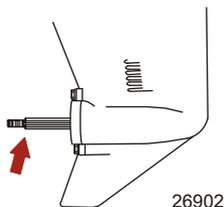
3. Нанесите смазку Quicksilver или Mercury Precision 2-4-С с тефлоном или специальную смазку 101 на следующие детали.
