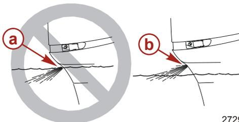
**a** - Выхлопное отверстие под водой (неправильно)
