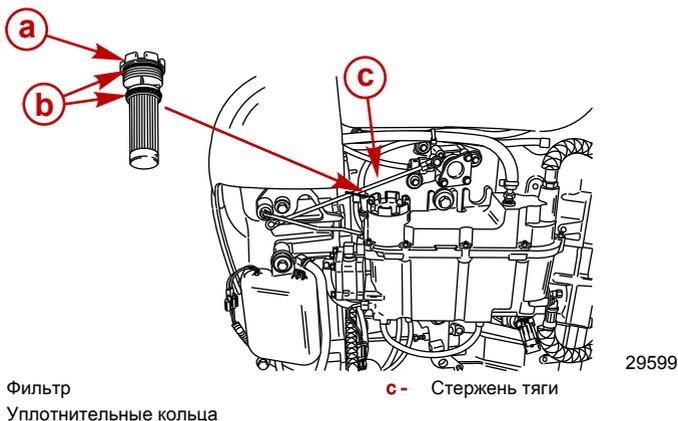
2. Установите топливный фильтр и надежно закрепите его.
