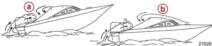
**a** - Эксплуатация катера со слишком большим углом носового дифферента.
