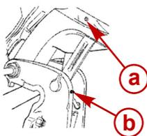
**a** - Держатель шарнирного соединения
