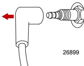
2. Снять и проверить свечи зажигания. Заменить свечу при износе электрода или шероховатости, трещине, поломке или загрязненности изолятора.
