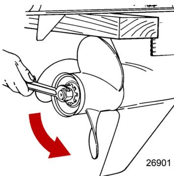
5. Сдвиньте и снимите гребной винт с вала. Если гребной винт заклинило на валу и его невозможно снять, обратитесь к уполномоченному дилеру для выполнения этой процедуры.
