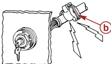
**b** - Звуковой сигнал, соединённый с замком зажигания
