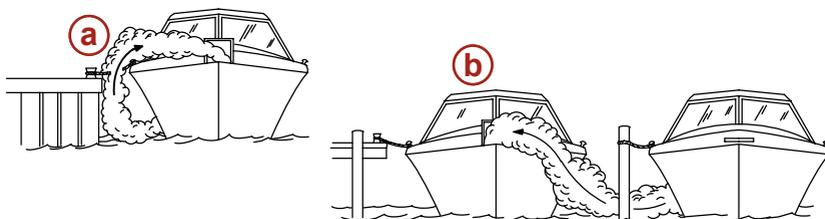
**a** - Работа двигателя, когда катер пришвартован в замкнутом пространстве.
