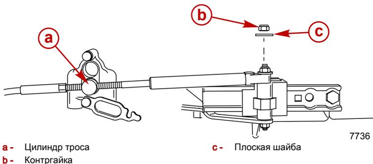
6. Проверьте отрегулированное положение троса переключения передач следующим способом:
