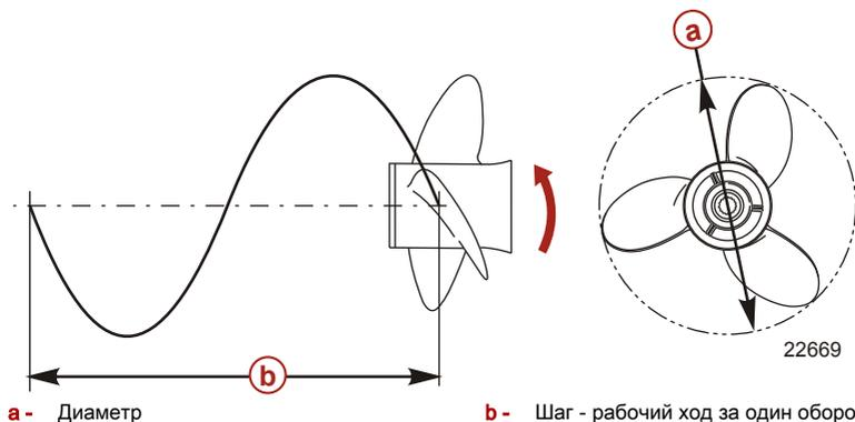
Ниже приводятся основные сведения о гребных винтах, которые помогут определить, какой гребной винт лучше всего подходит для вашего катера.
