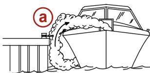
**а** - Работа двигателя, когда катер пришвартован в замкнутом пространстве.
