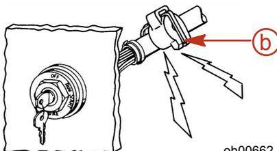
**b** - Звуковой сигнал, соединённый с замком зажигания
