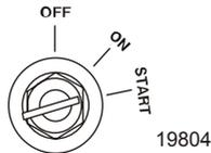
**ПРИМЕЧАНИЕ:** Система электронного пуска автоматически заправит двигатель (закроет воздушную заслонку) и увеличит скорость холостого хода для запуска.
