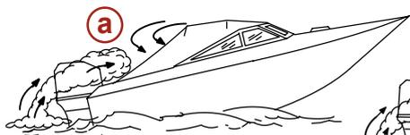
**а** - Эксплуатация катера со слишком большим углом носового дифферента.
