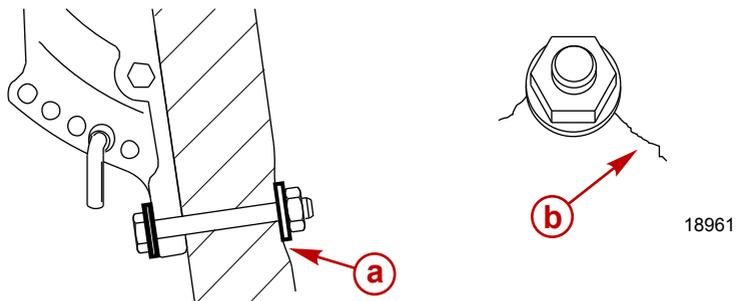
**a -** Деформация транца при закручивании болта
